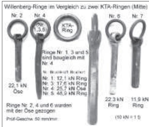
ge (nur durch Korrosion allein wird der Ring in 2 Jahren 0,2 mm dünner, nach ISO 9224). Die mittlere Kurve in Abb.1 zeigt die Bruchkraft solcher Ringe. Selbst im Neuzustand halten 9-mm-Ringe mit 43 kN weniger als normkonforme 12-mm-Ringe nach 50 Jahren im Fels (49 kN). Nach 50 Jahren halten 9-mm-Ringe theoretisch noch mindestens 23 kN, und mit dem Sicherheitsfaktor 2 halbiert noch mindestens 12 kN.
