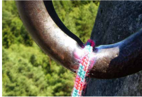
Beispiel einer durch Seilabrieb "eingelaufenen" Abseilöse.
