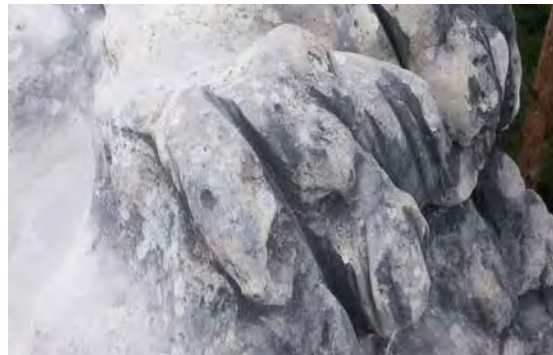
Seilspuren durch falsche Seilführung.
