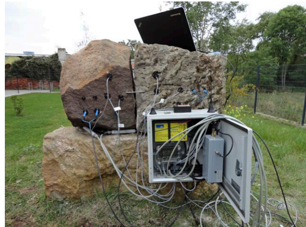
Felsfeuchtemessungen im Postaer und Cottaer Sandstein auf dem Gelände des SBB in Dresden-Mitte (von 2016 bis 2018)
