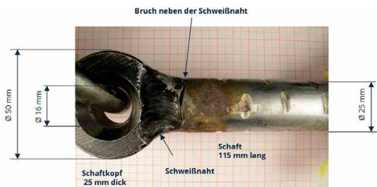
Abb. 2: Maße des gebrochenen Rings
