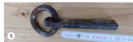
Bild 6: verbaute Gerüstöse Bild 7: ausgebohrte Gerüstöse Material: Gerüstösen sind nicht zulässig!
