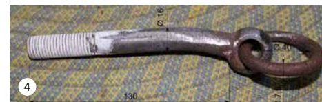
Bild 4: minderwertiger Ring, Augenschraube Material: nicht normkonform. Augenschraube mit eingeschweißtem Ring (oft von Th. Willenberg so verbaut).
