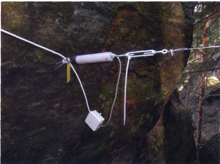
Meßsonde zur Beobachtung von geologischen Veränderungen eines Sandsteinstockes (Gebiet Goldener Ranzen) Foto: Jan Hänel
